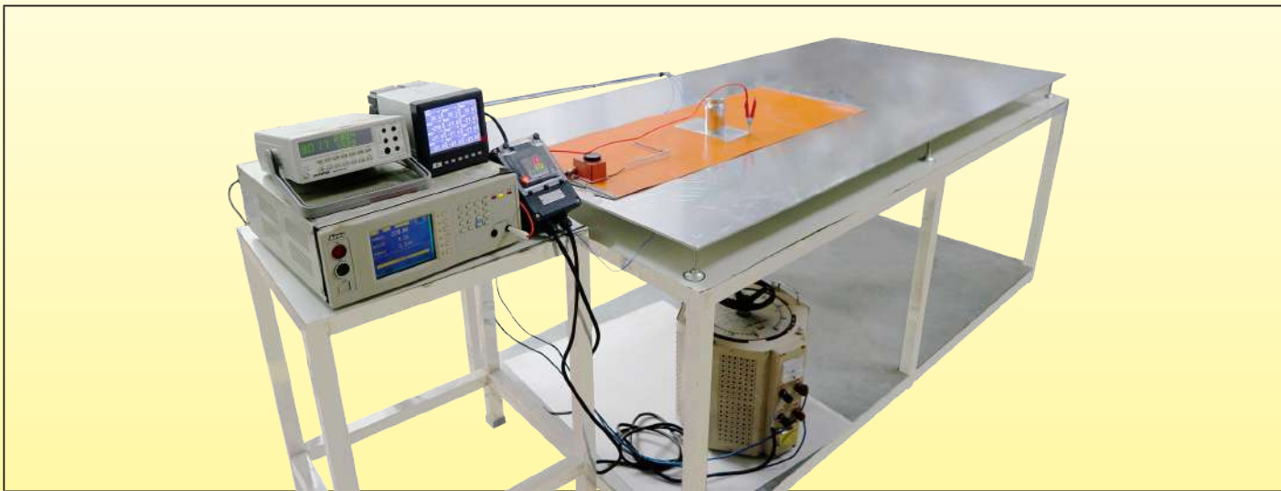
Messgeräte für den Gesamtleckstrom im heißen Zustand
