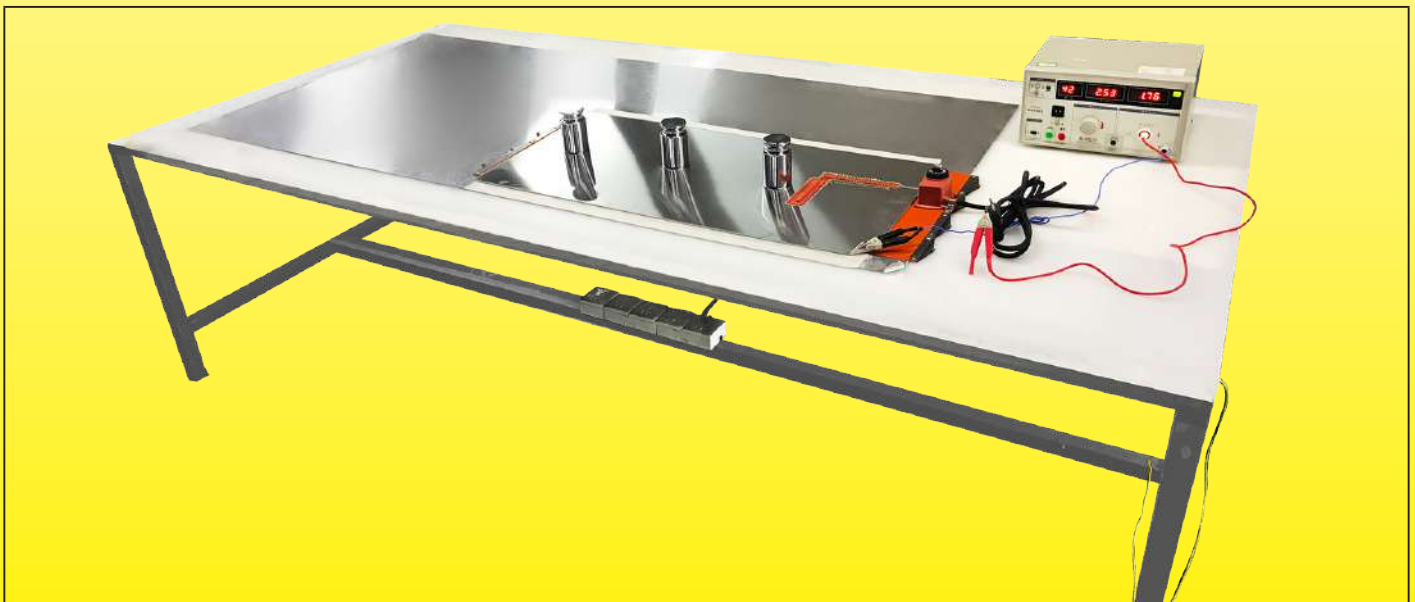
Messgeräte für den Gesamtleckstrom im kalten Zustand
