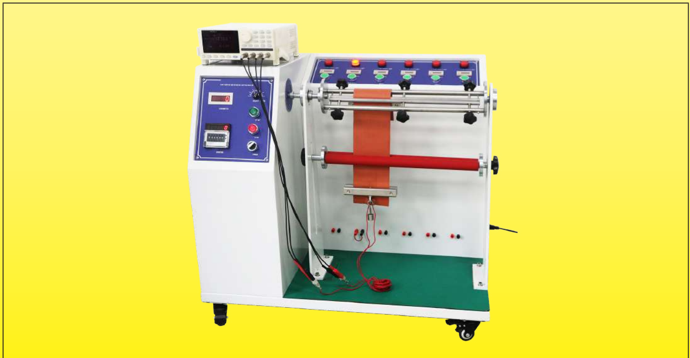
Flexible Silikonheizung während des Biegetests
