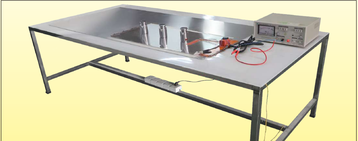
Gerät zur Messung des Isolationswiderstandes. Die gemessenen Werte sind immer größer als 0,1Gohm
